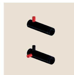
Prise de pression sur le réseau hydraulique
