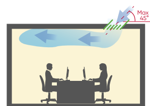
Cas d'un diffuseur plafonnier : l'angle de diffusion doit être inférieur à 45° pour assurer l'effet Coanda
