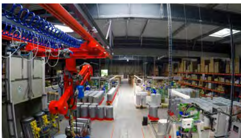
Nouvel espace robotisé pour la fabrication des chauffe-eau thermodynamiques
