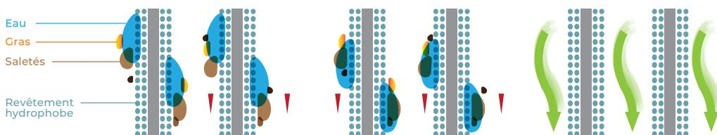
Les unités intérieures Toshiba disposent toutes de la solution unique Magic Coil® à savoir, un revêtement spécial hydrophobe sur les échangeurs.
