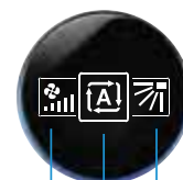
Vitesse de ventilation | Réglage des déflecteurs
