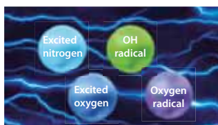
Ces électrons rentrent en collision avec les molécules de dioxygène et d'azote pour former 4 types d'éléments (azote excité, oxygène excité, radicaux d'hydrogène et radicaux d'oxygène).
