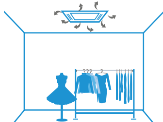
Distribution de l'air avec un filtre encrassé
