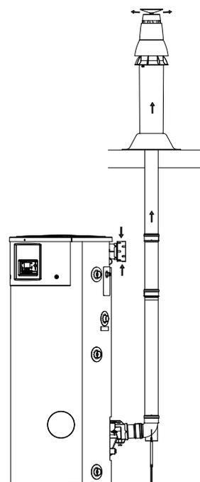
**Composition des kits fumisterie B23 :** filtre à air + nappe filtrante, conduit rallonge sortie fumées, coude support 90°, pied support réglable, collier clip, patte fixation conduit SG30-60, vis CBLX - m6 x 16 - CL8-8 - EZ, tige filetée M8 LG100, écrou HM 8 ZN DIN 934, rondelle plate M8, notice.
