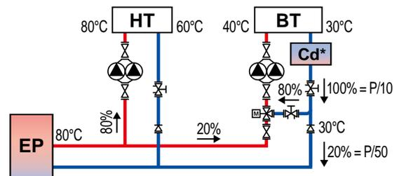
En 4 piquages le condenseur est situé entre la sortie du circuit BT et le bypass de sa vanne 3 voies.
