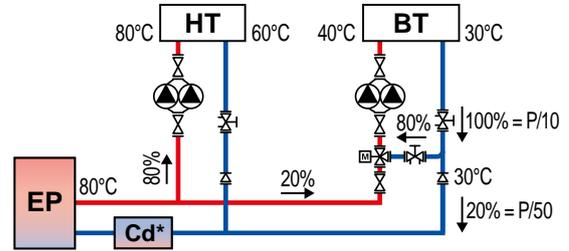
En 2 piquages le condenseur est irrigué par la T° de mélange des circuits, soit une température plus élevée que celle du circuit dont la loi d'eau est la plus basse
