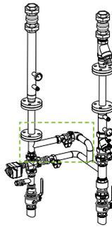
Note : Schéma DCH 65 ET 80 : Filtre positionné au-dessus du clapet
