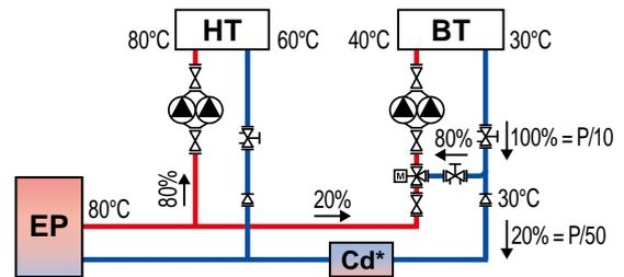
En 3 piquages le condenseur est situé sur le retour du circuit BT en aval du bypass de sa vanne 3 voies
