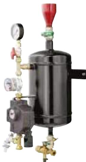
Le module de remplissage assure la fonction de remplissage de l'installation avec tous les organes nécessaires : pot d'injection, compteur d'appoint impulsible, groupe de remplissage, robinet d'arrosage avec clapet HA. Il offre la possibilité de lui raccorder le vase d'expansion.
