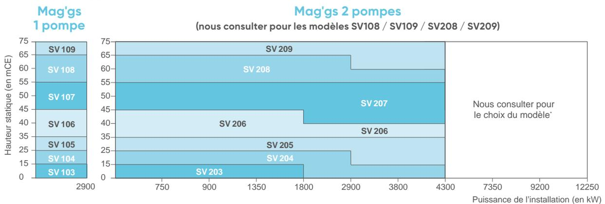
Valeurs données pour un régime d'eau 90/70 (c'est à dire pour une température moyenne maximale de 80 °C), une température de remplissage minimale de 20 °C et un ratio de 12l/kW.
