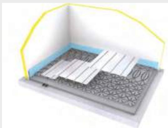
Les diffuseurs métalliques DIFF30/60 permettent une parfaite répartition de la chaleur émise ; ils sont rainurés tous les 15 cm pour s'emboîter dans l'isolant.
