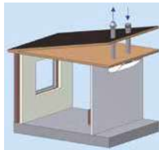
Entrée d'air et rejet en toiture
