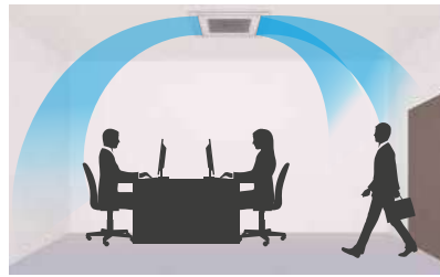
Diffusion d'air confortable en évitant le soufflage direct sur l'occupant.
