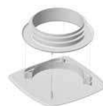
Installation de l'embase
