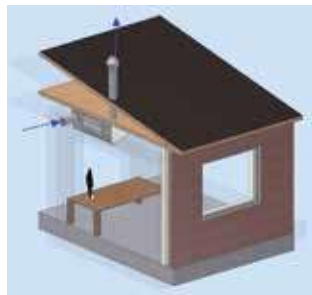
Entrée d'air murale et rejet en toiture
