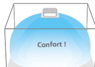
Diffusion homogène dans le volume
