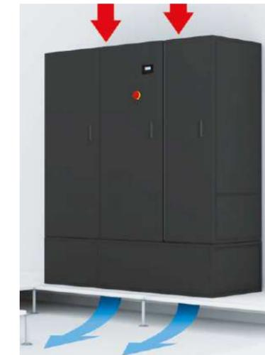
Configuration standard pour installation à l'intérieur du data center avec hauteur du sol surélevé inférieure à 550 mm. Dans ce cas, le support de hauteur fixe 550 mm, équipé de panneaux de fermeture latéraux, devra être installé sur le sol. Il est toutefois indispensable de vérifier que la hauteur du plafond permet une bonne aspiration de l'air.
