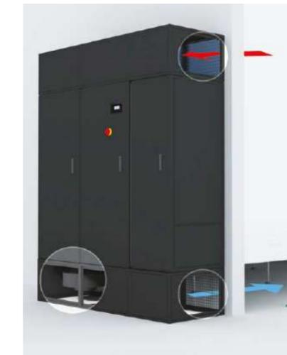
Configuration pour installation à l'extérieur du data center, sans sol surélevé et refoulement par l'arrière. Dans ce cas, le support de hauteur fixe 550 mm est équipé de panneaux de fermeture latéraux et de grilles de refoulement arrière. L'installation du plenum avec système d'aspiration arrière est en option, en l'absence d'un système de gaine.
