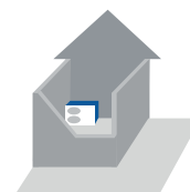
PAC placée dans une cour intérieure : +9 dB(A)
